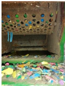
Figura 4 Trituración del plástico
